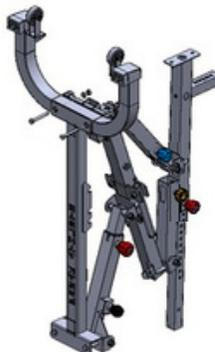
1.G. Usa las llaves para apretar completamente los pernos y las tuercas (usa el lado abierto de la llave en el interior y el lado cerrado hacia el exterior).
